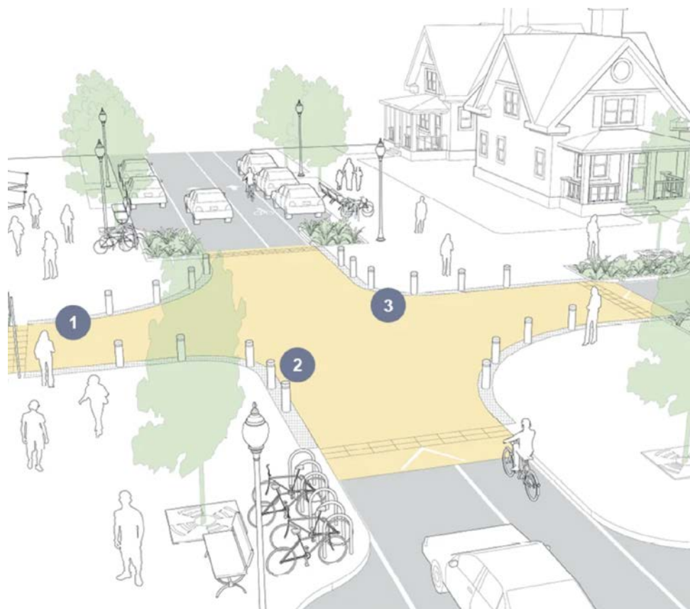
Figura 18. Ejemplo de intersección elevada
